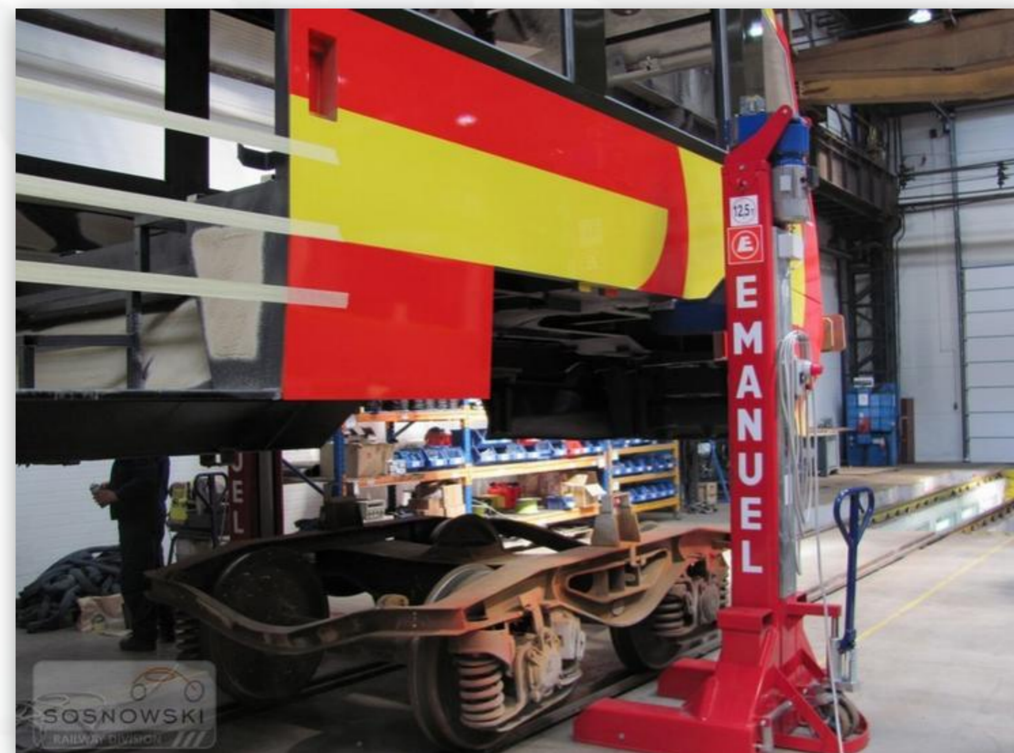
Pojazdy Szynowe PESA – Bydgoszcz 8x12,5 t. z przesuwem poprzecznym, odbiór TDT
